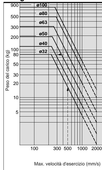
Esempio: Limite di carichi in estremità stelo quando il cilindro pneumatico ø63 viene messo in funzionamento a una max. velocità d'esercizio di 500mm/s. Vedere l'intersezione dell'asse laterale 500mm/s e la linea del 63 quindi estendere l'intersezione a sinistra. Il carico ammissibile è di 80Kg.
